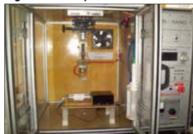
Fig 2. Actual Setup for Electrospinning
