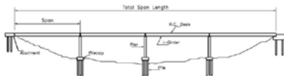
FIG. 3 LONGITUDINAL SECTION FOR SIMPLY SUPPORTED BRIDGE
